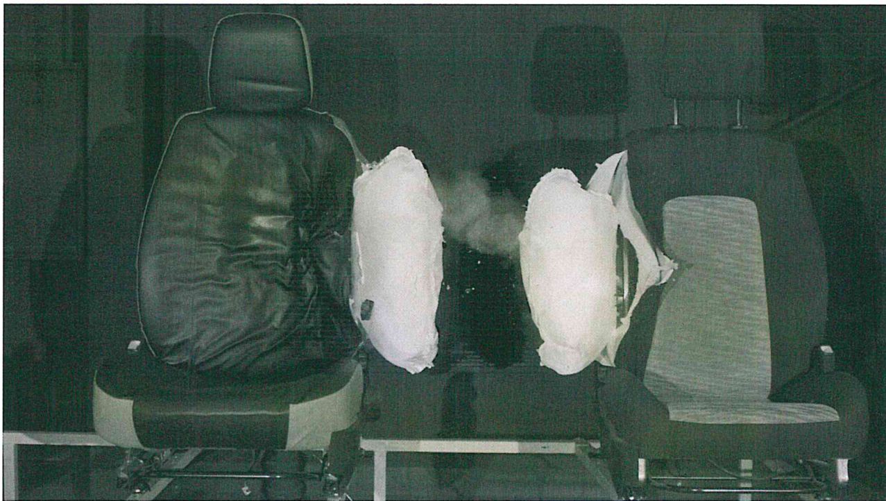
Fot. 11. Czas 7,00 ms – maksymalne napelnienie poduszek gazowych Photo 11. Time 7,00 ms – maximum filling of AIR BAGS
