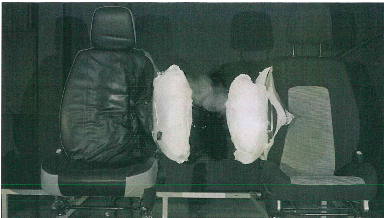
Fot. 6. Maksymalne napętnienie poduszek gazowych (siedzenie z badanym pokrowcem po lewej stronie) Photo 6. Maximum filling of the AIR-BAGS (seat with the tested cover on the left side)
