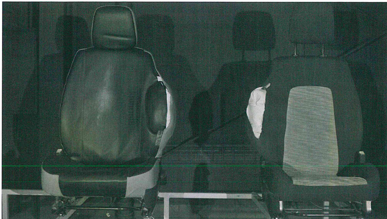
Fot. 10. Czas 2,75 ms – rozerwanie materiału badanego pokrowca Photo 10. Time 2,75 ms – tearing of the material of the tested cover
