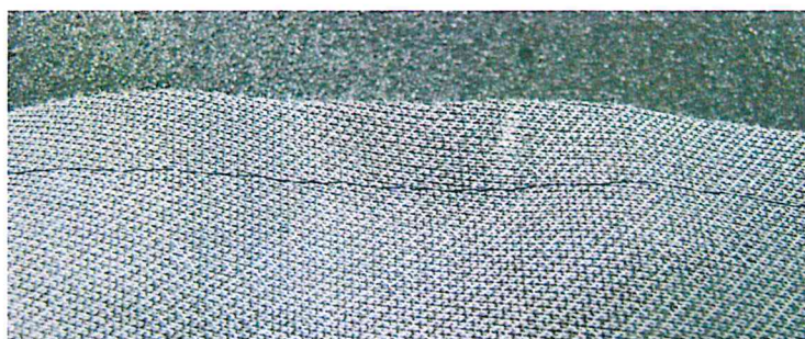
Fot. 2. Sposób przeszycia w miejscu zaprojektowanym do rozerwania na skutek detonacji poduszki gazowej Photo 2. A method of sewing in a place designed to be torn apart due to the detonation of AIR-BAG
