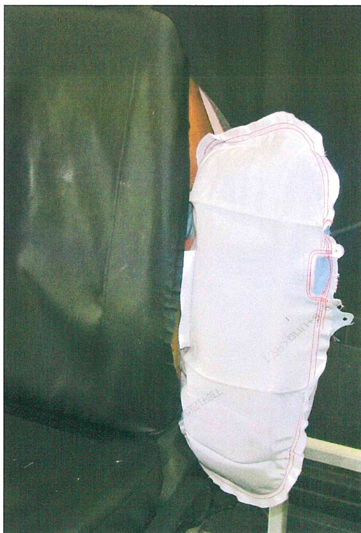
Fot. 7. Badany pokrowiec po badaniu czasu napętniania poduszki gazowej Photo 7. Tested cover after testing the filling time of the AIR-BAG
