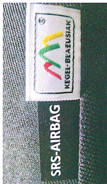
Fot. 5. Oznakowanie miejsca poduszki gazowej Photo 5. AIR-BAG place marking
