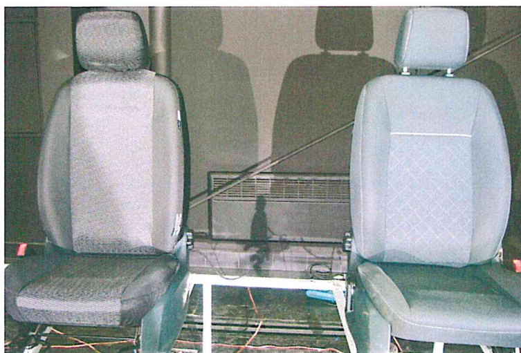
Fot. 1. Obiekt badań – pokrowiec Ares, typ LF airbag (po lewej stronie) Photo 1. Test object - cover Ares, type LF airbag (on the left)
