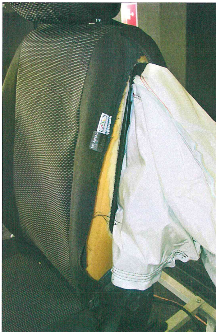
Fot. 7. Badany pokrowiec po badaniu czasu napelniania poduszki gazowej Photo 7. Tested cover after testing the filling time of the AIR-BAG
