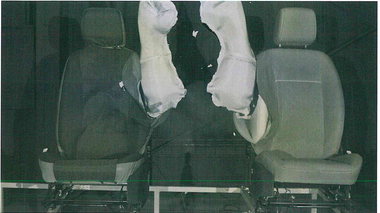
Fot. 6. Maksymalne napelnienie poduszek gazowych (siedzenie z badanym pokrowcem po lewej stronie) Photo 6. Maximum filling of the AIR-BAGS (seat with the tested cover on the left side)
