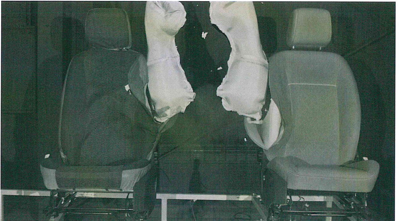
Fot. 11. Czas 12,75 ms – maksymalne napelnienie poduszek gazowych Photo 11. Time 12,75 ms – maximum filling of AIR BAGS
