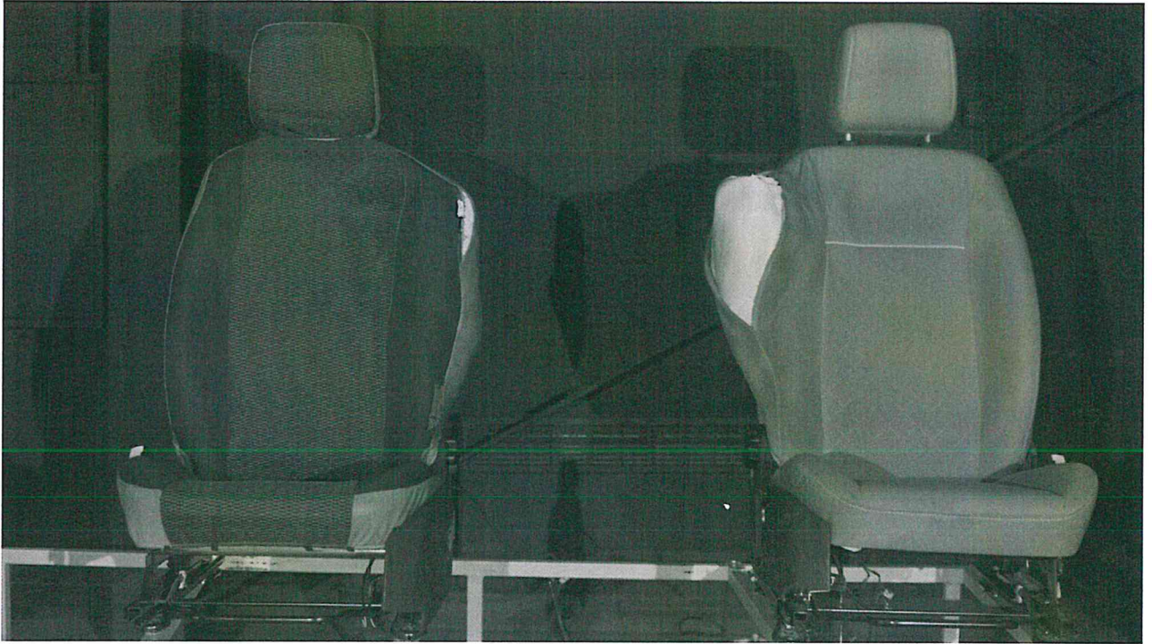
Fot. 10. Czas 3,75 ms – rozerwanie materiału badanego pokrowca Photo 10. Time 3,75 ms – tearing of the material of the tested cover
